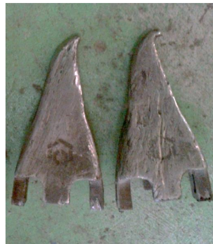
Gambar 1 Deformasi gigi bucket yang terjadi di PT. Bukit Asam
